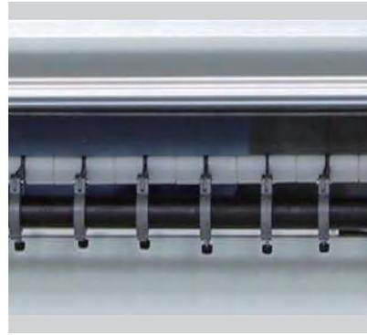
采用加大加粗卷布轮设计，充分满足双面组织对牵拉力的更高要求以及增强牵拉的平稳性能
